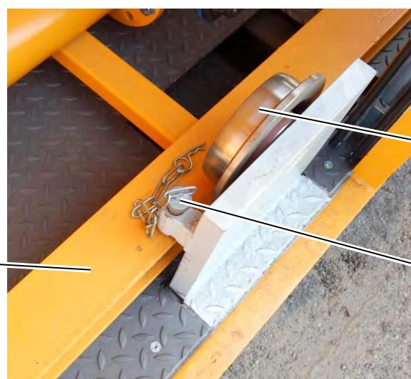
Abbildung 28: Sicherungsbolzen
